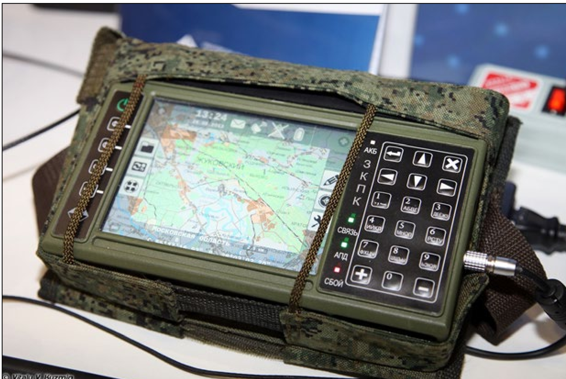
Защищенный командирский ПК. Предназначен для решения задач управления и ориентирования в тактическом звене младшего командного состава уровня взвод/отделение (Platoon/squad commander tablet PC)
