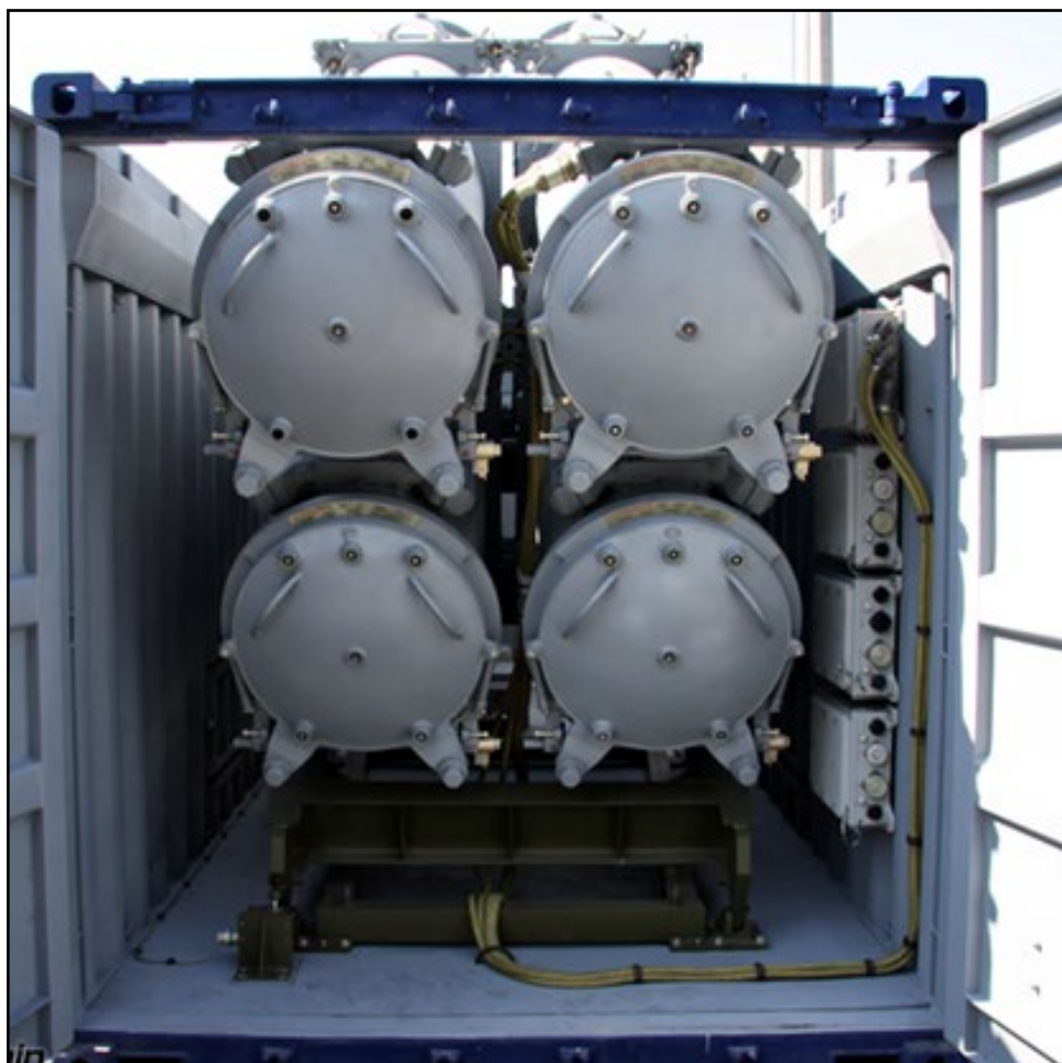
Контейнерный комплекс ракетного оружия Club-K в 20-футовом исполнении с ракетами X-35УЭ (Container missile system Club-K in 20-foot variant with Kh-35UE missile).
